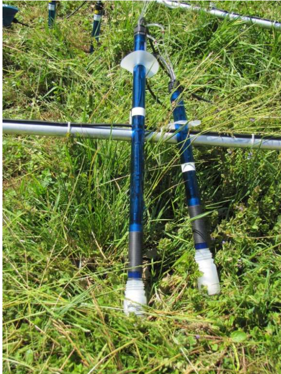
Abb. 5 und 6: T8 Tensiometer lose und eingebaut
