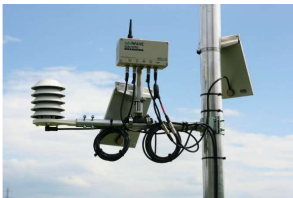
Abb. 8: Vaisala-Sonde (links), Datenübermittler (oben) und Solarpanels (Mitte, rechts)
