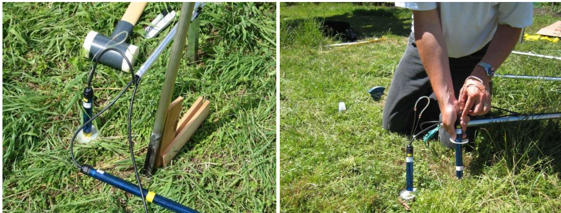
Abb. 1 und 2: Die Tensiometer müssen in einem Winkel von 5° gesetzt werden.
